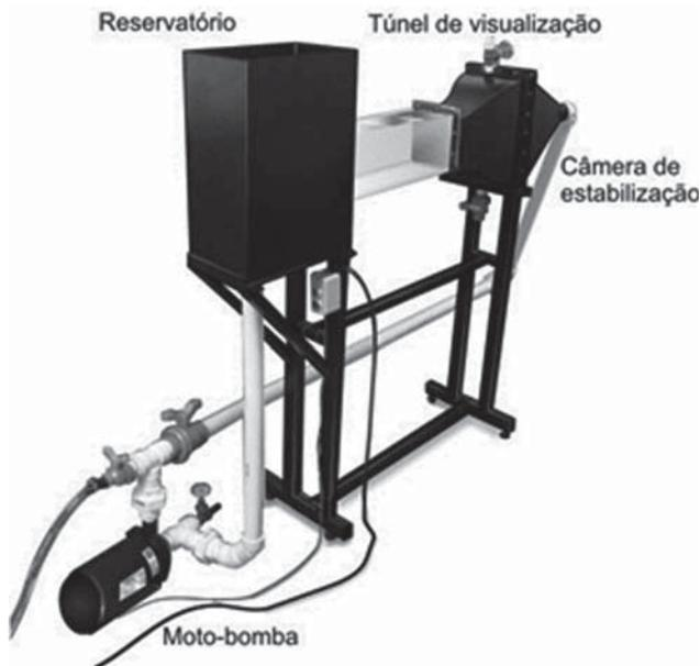
Figura 1 - Túnel hidrocinemático
