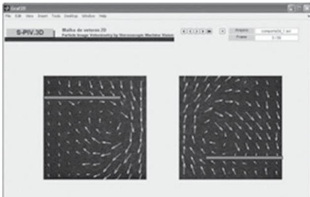
Figura 16 - Tela de resultados – ensaio tridimensional de comporta de fundo
