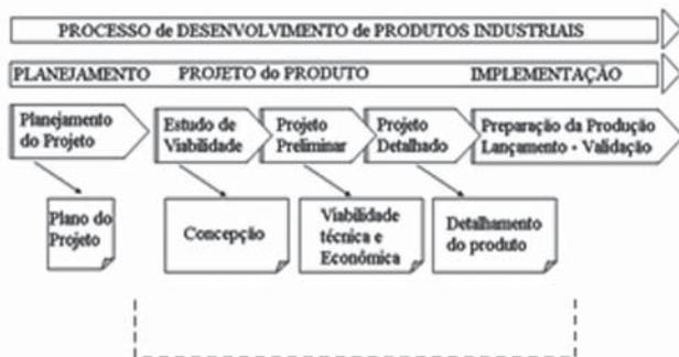
Figura 1 - Processo de desenvolvimento do produto, adaptado Dedini (2002)
