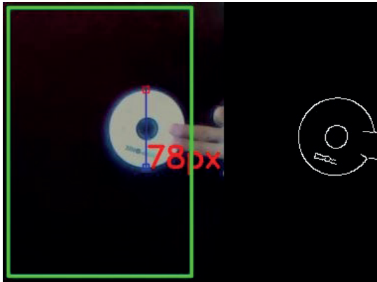
Figura 20: Detecção de borda dentro da região de interesse
