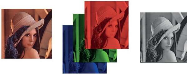
Figura 2: Representação de uma imagem nas bandas RGB e em escala de cinza
