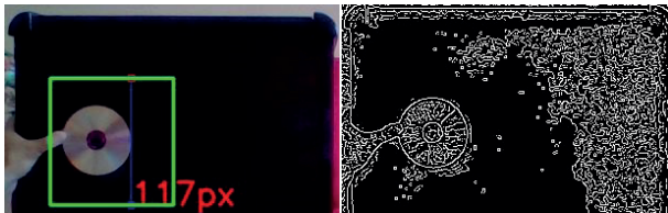
Figura 21: Detecção de borda com limiarização mal aplicada
