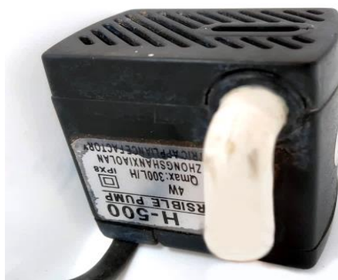
Figura 5 – Bomba d'água submersível utilizada no projeto
