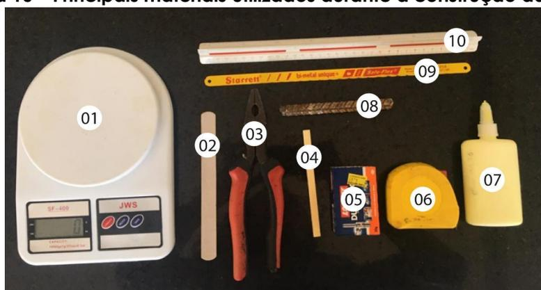
1. Balança; 2. Lixa de papel; 3. Alicate; 4. Palito de Picolé; 5. Cola da marca Durepox; 6. Fita Métrica; 7. Cola para Madeira; 8. Vergalhão de ferro. 9. Lâmina de serra manual; 10. Escalímetro.
