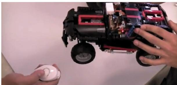
**Figura 6: Carrinho feito com LEGO e controlado por controle Nunchuck, via Bluetooth.**
