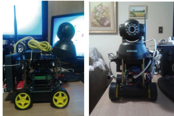
Figura 11: Projeto de carrinho controlado via Ethernet.
